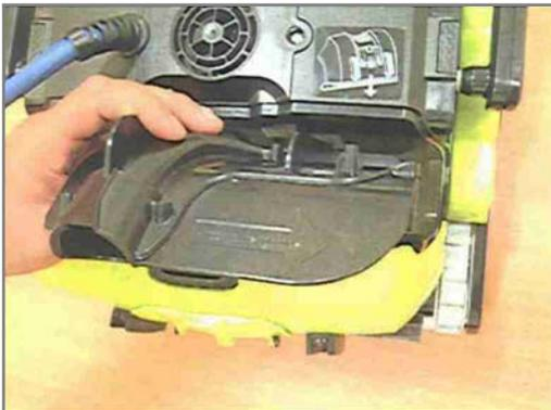
Entfernen Sie beide Filterkartuschen des BIO.
