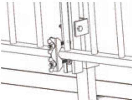
Befestigung bei 10°-30° Montage
