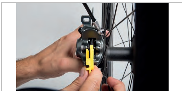
Abbildung 48: Bremsbelag im eingebauten Zustand mithilfe der Transportsicherung prüfen
