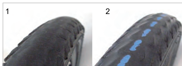
Abbildung 46: Reifen ohne Profil, der gewechselt werden kann (1) und Reifen mit durchscheinendem Pannenschutz (2), der gewechselt werden muss
