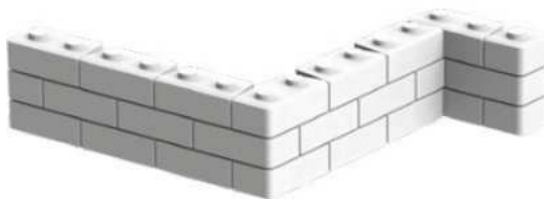
Ausführung einer Innen- und Außenecke
