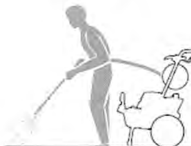
Abb. 10: Betriebsposition des Geräts
