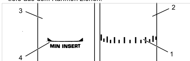
Abbildung 24: Detailansicht Sattelstützen, Beispiele für die Markierung der Mindesteinstecktiefe
