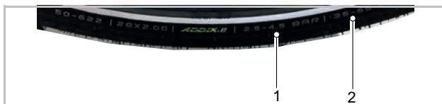
Abbildung 48: Angabe Fülldruck in bar (1) und psi (2)
