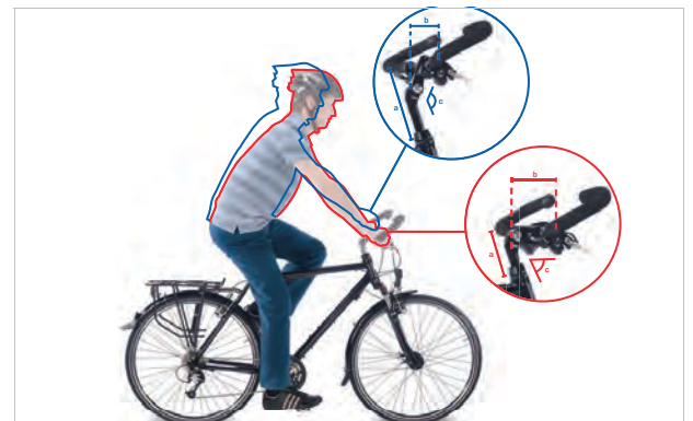
Abbildung 29: Citybike (blau) und Trekkingrad Position (rot) durch Winkeländerung
