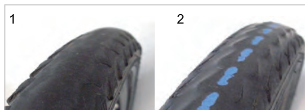
Abbildung 49: Reifen ohne Profil, der gewechselt werden kann (1) und Reifen mit durchscheinendem Pannenschutz (2), der gewechselt werden muss
