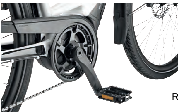
Abbildung 19: R Pedal im rechten Kurbelarm
